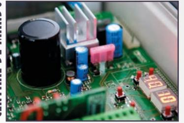
De fácil acceso gracias a su posicionamiento en la parte superior del cuerpo de la barrera, permite la completa y precisa gestión de la barrera gracias al controlador digital.
