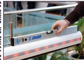
Inclinación de la barra directamente manejable por la central a través de parámetros que permiten de forma digital, ajustar en décimas de grado la inclinación de la barra en la apertura y el cierre, durante la instalación, mantenimiento y uso operativo.
