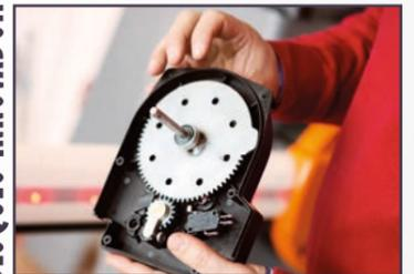
Desbloqueo de llave manual mecánico capaz de desbloquear la barrera en cualquier eventualidad y situación gracias a su excelente mecánica basada en engranaje y cojinete excéntrico de desbloqueo.
