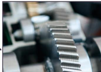
Todos los engranajes del reductor están estrictamente fabricados y procesados en **Roger Technology** y se producen en acero y bronce con dientes helicoidales inclinados 15° con el fin de hacer su movimiento siempre perfecto.
