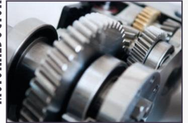
Joya mecánica completamente hecha de aluminio, acero y bronce, con todos los engranajes helicoidales, montado sobre cojinetes de alta calidad y colocado en asientos específicos con el fin de tener una precisión absoluta entre los ejes de los engranajes.
